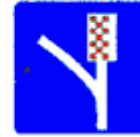
6.5 Полоса аварийной остановки
